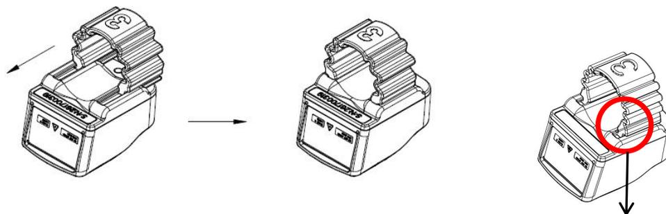
硅胶指环套未推到机体卡槽的最底端，影响充电。
